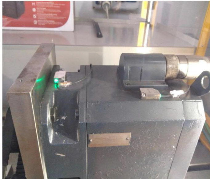
Figura 10: Sensori per la rilevazione delle condizioni operative del motore testato
