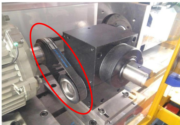
Figura 9: Accoppiatore meccanico con motore della coppia resistente
