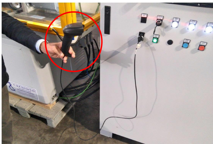
Figura 19: Lettore codice a barre per acquisizione informazioni dal gestionale
